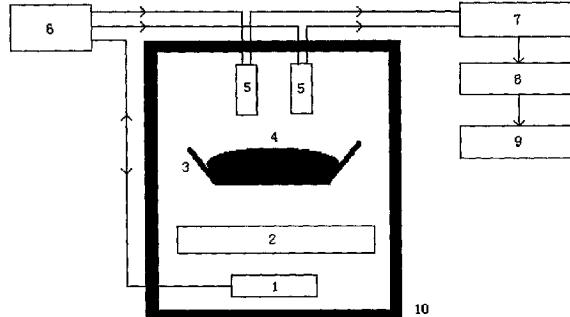
1. 一种基于脉冲快热中子瞬发伽玛射线分析技术的水泥物料成份在线检测系统,包括中子发生器(1)、慢化体(2)、 $\gamma$  射线探测器(5)、电子放大系统(7)、数据获取系统(8)、计算机数据处理和显示系统(9)、复合屏蔽防护系统(10),输送带(3)穿过复合屏蔽防护系统(10),待检测水泥原料(4)位于带动其前进的输送带(3)上,慢化体(2)安装在复合屏蔽防护系统(10)中并位于输送带(3)的下方,中子发生器(1)也安装在复合屏蔽防护系统(10)中并位于慢化体(2)的下方,在水泥原料(4)的上方、复合屏蔽防护系统(10)中至少安装有两个 $\gamma$  射线探测器(5),它们通过传输线与电子放大系统(7)相连,电子放大系统(7)与数据获取系统(8)相连,数据获取系统(8)与计算机数据处理和显示系统(9)相连,其特征是所述的慢化体(2)由铅层和聚乙烯层组合构成,它们的厚度比为,铅层:聚乙烯层=1:0.4-0.8,它们的总厚度为8-10cm。
