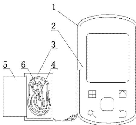
1. 一种新型手机套,其特征在于:它由手机套、铁片、挂件、吸铁石、翻盖、耳机、卡槽构成;所述的手机套的下端设有挂件,后端设有铁片,内部设有手机;所述的挂件为方形状,上端设有吸铁石,前端设有翻盖,内部设有耳机和卡槽。
