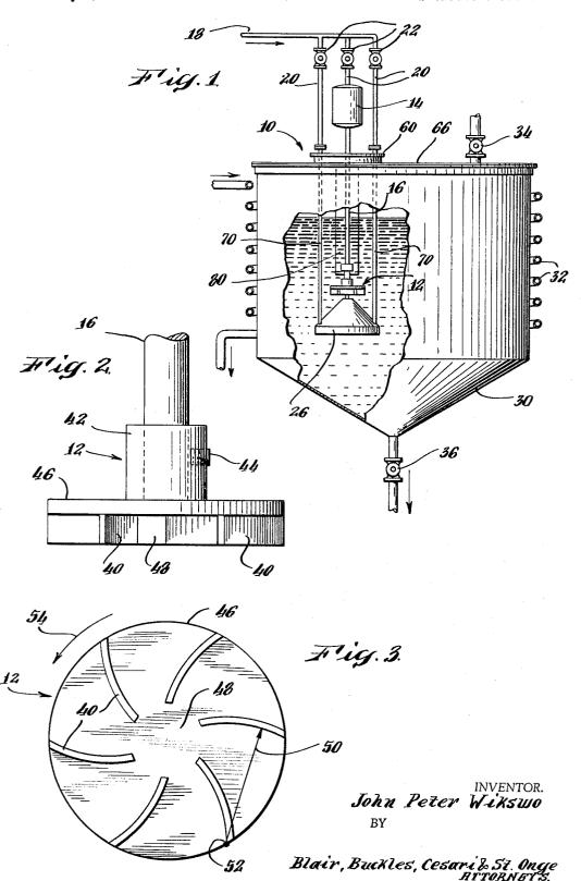
APPARATUS FOR DISPERSING A GAS IN A LIQUID
