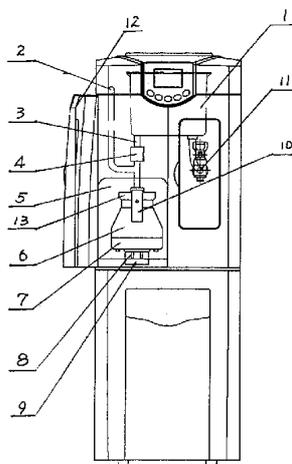
1. 一种由加热壶、阀门、进水管、储水罐及饮水机机体组成的加热可移动分离式饮水机，其特征在于加热壶呈活动式放置于饮水机的进水管处。
