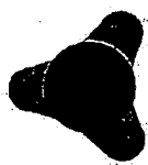
Trilobada com pontas Ambos o núcleo e as pontas são expostas na superfície. Fiação seria difícil para polímeros incompatíveis.
