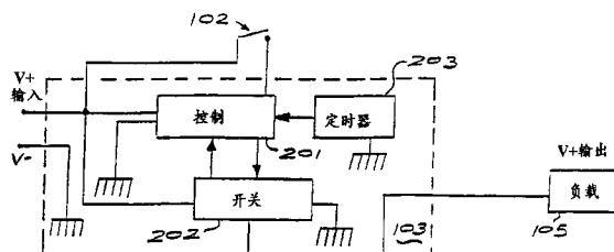
1. 一种用于控制负载的电源供给的电子设备,包括电源(101)或用于电源的接线、电源开关(202)、负载(105)或用于负载的接线,所述电子设备包括微芯片(103, 201, 203),该微芯片连接到形成人机接口开关(102, 106, 1210)的触摸传感器开关,所述人机接口开关向该微芯片提供相应的指示人机接口开关操作的控制信号,所述电子设备配置成使得不管所述人机接口开关(102, 106, 1210)操作状态和 / 或负载(105)启动状态,所述微芯片都被供电;所述电子设备还符合下列配置:
