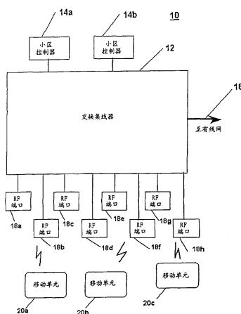
1. 一种用于操作包含无线电模块、数字处理器、随机存取存储器和只读存储器的 RF 端口的方法，其特征在于，包含把引导装入程序存储在所述只读存储器中，其中，配置所述 RF 端口以完成低级 MAC 功能；操作所述数字处理器运用所述引导装入程序把指令从计算机下载到所述随机存取存储器；操作所述 RF 端口以完成低级 MAC 功能并在所述下载指令下操作所述 RF 端口以运用所述无线电模块发送和接收消息。
