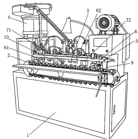
1、一种工具插内架冲压机，其包括一机架，其特征在于：于该机架上设有一传送装置，在该传送装置的上方依次设有一将电线外皮剥掉的剥皮装置、一将两股小电线分开的分线装置、一将电线端部切平的切平装置、一将电线按设定形状定型的定型装置、一输送端子装置和一将端子与电线端部冲压在一起的冲压装置。
