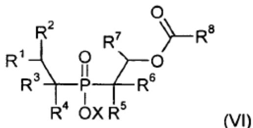
c) el derivado del ácido dialquil-fosfínico mono-funcionalizado (VI) se hace reaccionar en presencia de un catalizador C para dar el derivado del ácido dialquil-fosfínico mono-funcionalizado con hidroxi (III)
