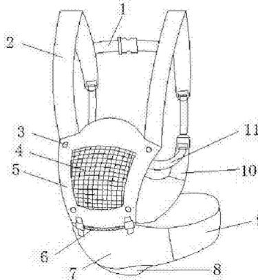
1. 一种四季通用防搁腿腰凳,其特征在于:包括肩带、保护面、凳体、腰带、固定面、侧腰带、拉链、连接带、按扣、挡风面板;所述肩带包括左肩带和右肩带;所述肩带一端和保护面上部固定连接,另一端通过插扣和固定面上部的拉带连接;所述固定面下部和保护面下部内侧固定连接;所述保护面下部外侧和凳体通过拉链和插扣连接;所述凳体和腰带水平固定连接;所述侧腰带一端固定在保护面侧边,另一端通过插扣固定在固定面上部的拉带上;所述连接带由两个部分通过插扣连接组成,连接带两端分别固定在左右肩带上;所述挡风面板通过按扣固定在保护面上。
