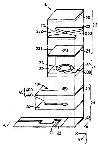
1、一种传感器，其含有过滤部、供给装置和反应部，上述供给装置通过毛细管现象将样品液供给至上述过滤部，上述反应部含有试剂，该试剂与在上述过滤器过滤后的样品液相反应。
