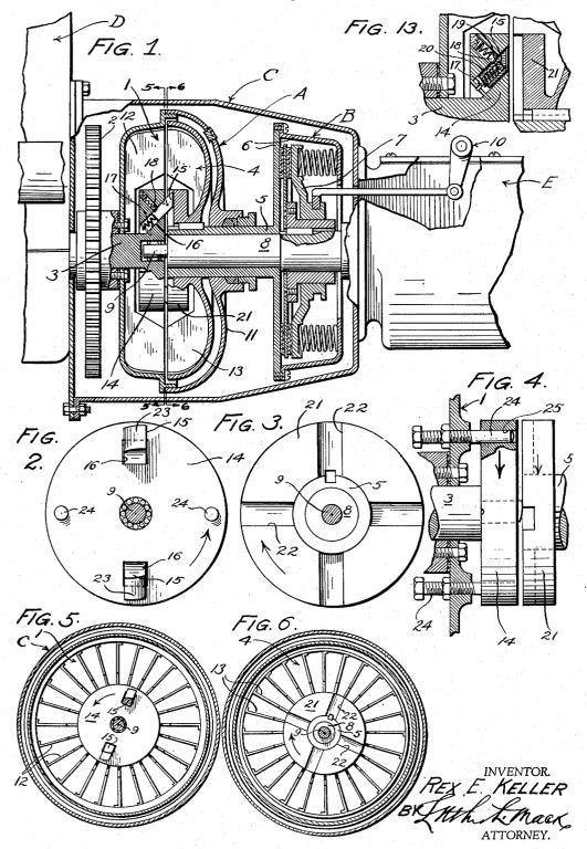
AUTOMATIC LOCKUP FOR FLUID DRIVE CLUTCHES
