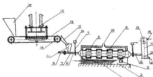
1. 一种裂解化炉及其配套装置，其特征是：有一个固定于地面的基座，基座的上端固定有炉体，炉体前端设置有炉门，炉体的上端设有排气孔；炉体中间安装有二头伸出到炉体外的炉胆；炉胆伸出炉体外的二头由二根链条吊住炉胆；炉胆内壁安装有斧式内凸钉；炉体内炉胆的下端还安装有气体加热管；炉体两头的一端设置有与炉胆连接为一体的伸出炉体外的送料管道，送料管道直接与活塞送料管相接，活塞送料管内安装有推料活塞，推料活塞是固定在其后端的油缸上的；活塞送料管中间上端设置有一个进料口，进料口的上端设置有进料斗；进料斗的侧端设置有送料传送带，传送带的二头设有传动轮，上端传送带的中间设置有油压脱水压机，下端传送带的下面设置有污水处理池；传送带的另一端头上端设置有上进料口；炉体两头的另一端设置有与炉胆连接的卸料道，卸料道的另一端头是伸入到水封洗气塔内的；水封洗气塔的上端设置有与塔内相通的气体回收管道，水封洗气塔上端内面还安装有喷淋头，水封洗气塔内装有定量的水，水封洗气塔的下端侧面安装有炭、油和灰渣出料口。
