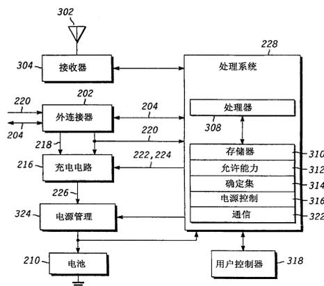
1. 一种用于对在便携式通信设备内的电池进行充电的方法，所述便携式通信设备具有外连接器，该外连接器包括外电源节点和具有组合电源节点的数据总线，该方法包括步骤：
