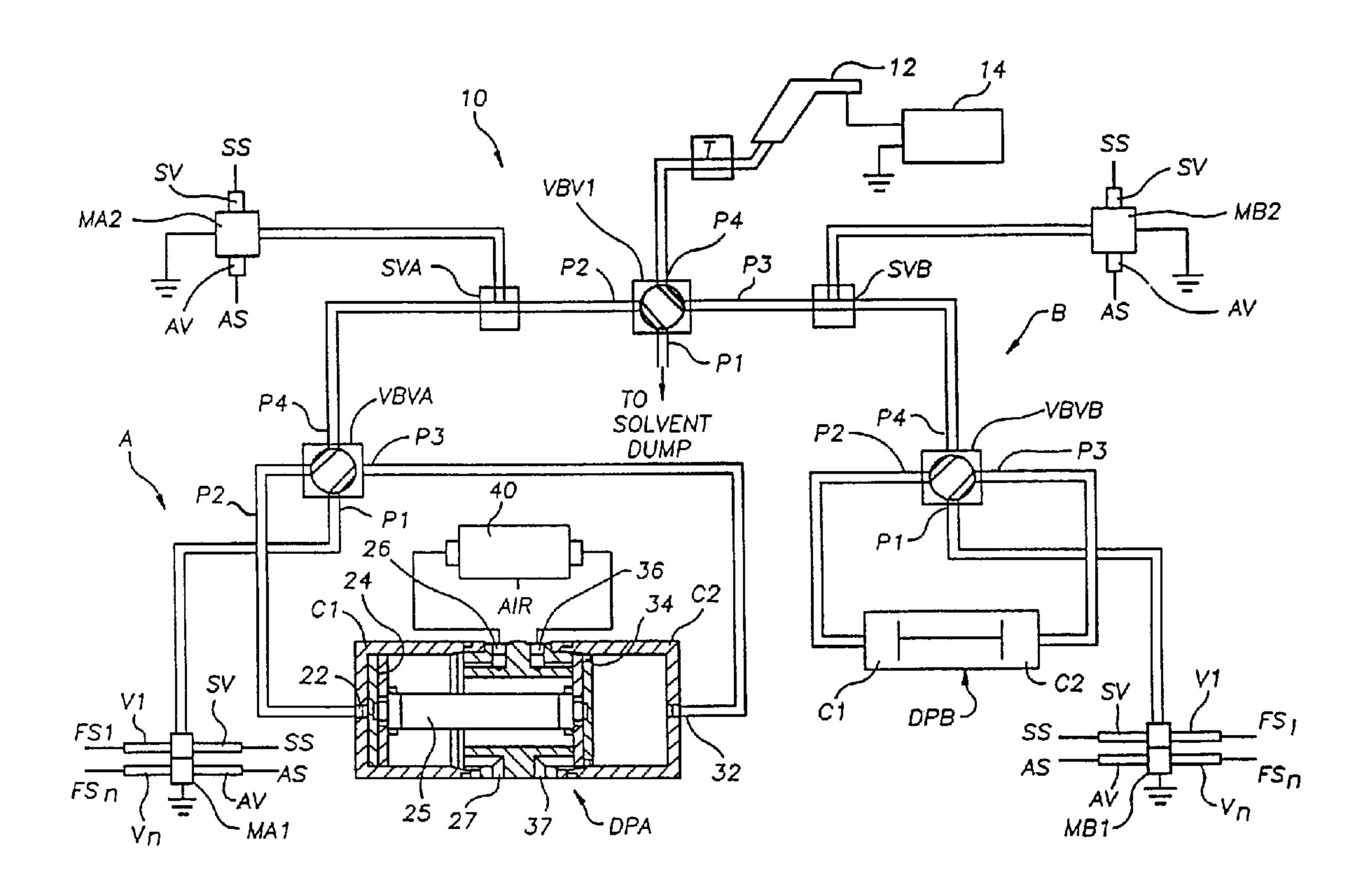
(57) Méthode et système pour l'alimentation en matériaux de revêtement conducteurs, d'un distributeur électrostatique, avec arrangement parallèle de soussystèmes couplés de manière sélective au distributeur par une soupape de coupure de tension à quatre voies, qui isole les sous-systèmes. Ces sous-systèmes comportent
