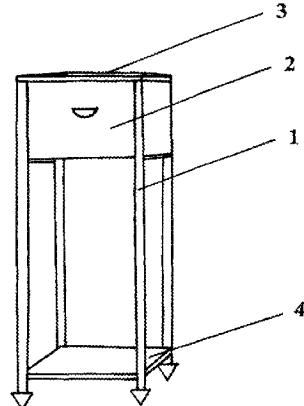
1. 一种抽屉式电话机台桌，其特征在于：它由实木制作而成，包括脚柱、抽屉组件、桌面、置物板，脚柱为底部带圆锥头的圆柱杆，抽屉组件由抽屉和左右侧板、后侧板、底面板所构成的抽屉盒组成，抽屉为上面开口、正面中间靠上位置设有一弧状片拉手的方形体斗式结构，桌面、置物板均为正方形板面，四根脚柱竖置四角位置，抽屉组件设置四根脚柱内侧上部且与其固联，桌面水平设置四根脚柱上面且与其固联，置物板水平设置四根脚柱内侧下部且与其固联。
