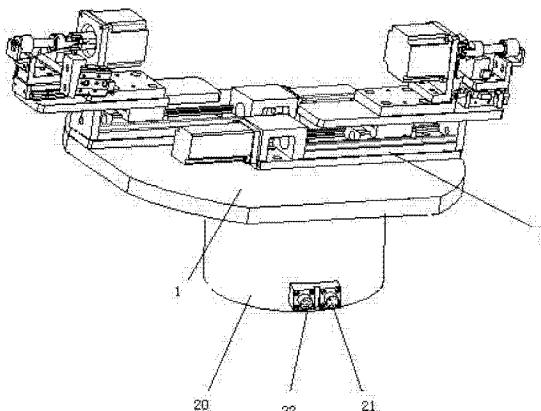
1. 一种高精度旋转定位工作台，包括一固定旋转台基板、两个进给工作台、一直驱电机和一电源端口，其特征在于：所述固定旋转台基板上面中心对称地安装两进给工作台，所述直驱电机安装在固定旋转台基板的下方，所述电源端口安装在直驱电机上；所述进给工作台包括一线性模组安装板、一模组支撑座、两气缸、两电机、一钻针旋转轴、一夹头松紧夹具、一缓冲套、一弹簧、一万向节、一线性模组滑台板和一滚轴丝杆，模组支撑座位于线性模组安装板的上面，滚轴丝杆穿越模组支撑座，线性模组滑台板设于模组支撑座的上方，夹头松紧夹具设于线性模组安装板的左上边，弹簧环绕于缓冲套，钻针旋转轴穿于夹头松紧夹具和缓冲套并与万向节连接，其中一气缸设于夹头松紧夹具的下方，另一气缸设于万向节的下方，其中一电机位于线性模组滑台板上连接于环绕有弹簧的缓冲套，另一电机位于模组支撑座的一端连接于滚轴丝杆。
