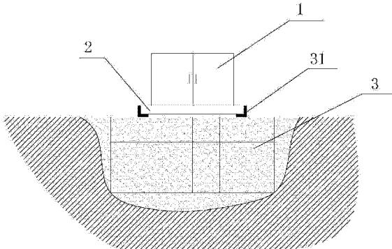
1. 一种基于扇形拼接板的易于定位的配电柜组件,其特征在于,包括:配电柜(1)、垫平板(2)及支撑架(3);
