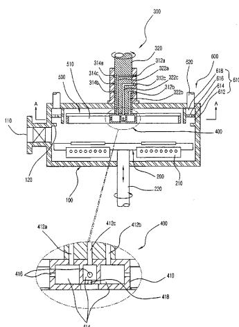
1、一种薄膜沉积设备，其具有用以在靠立于基座上的复数个基板上形成薄膜的反应室；该设备包括：
