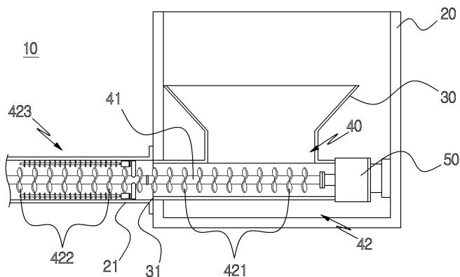
하여 구조물의 지지력을 향상시키고, 보강재 분사장치의 빅서 샤프트에 구동스크류장치와 막성이송수단을 마련하여, 교반시 구성성분이 균일하게 분포되어 교반 효율을 향상시키게 되는 보수보강재 균일 분사장치를 이용한 구조물의 보수 및 보강공법을 제공한다.
