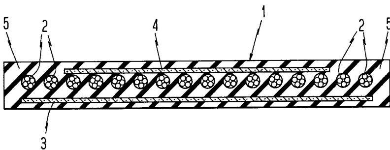
Die Erfindung betrifft einen Fördergurt für Rohrgurtförderer mit Überlappung des Fördergurtes an den Rändern bei der Gurtrohr-Bildung, bestehend aus Gummi oder gummiähnlichem Kunststoff und mehreren darin eingebetteten, in Längsrichtung des Fördergurtes verlaufenden Stahlseilen als Zugträger, die über die Breite des Fördergurtes mit gleichem Abstand untereinander angeordnet sind.
