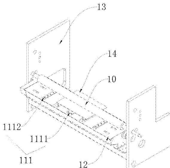
1. 一种无压辊除尘真空输送装置,其特征在于,包括除尘辊、多组皮带传送结构、真空风箱、支撑架以及瓦楞纸板,所述除尘辊包括长轴头、短轴头以及辊身,所述辊身一端与长轴头固定连接,且另一端与短轴头固定连接,所述多组皮带传送结构固定在真空风箱上,所述长轴头和短轴头分别固定在支撑架上的定位孔中,所述瓦楞纸板放置在皮带传送结构上进行传送,所述除尘辊辊身与瓦楞纸板相切,且辊身不间断式旋转,所述除尘辊表面还设置有粘吸清除微尘杂质的除尘胶层;启动输送皮带,瓦楞纸板一张一张的送入到输送皮带上,在瓦楞纸板经过除尘辊时,除尘辊在不断旋转的过程中除尘辊表面的除尘胶层将纸板表面的粉尘和碎纸屑全部粘走;
