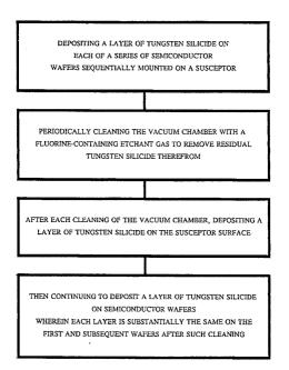
DEPOSITING A LAYER OF TUNGSTEN SILICIDE ON
