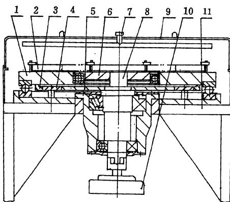
1、一种大型逆转式滚动轴承洗洁机，其特征是传动装置带动主轴和主轴上的内圈盘旋转；主轴上中心轮带动行星轮，内齿轮和内齿轮上面的外圈盘旋转。
