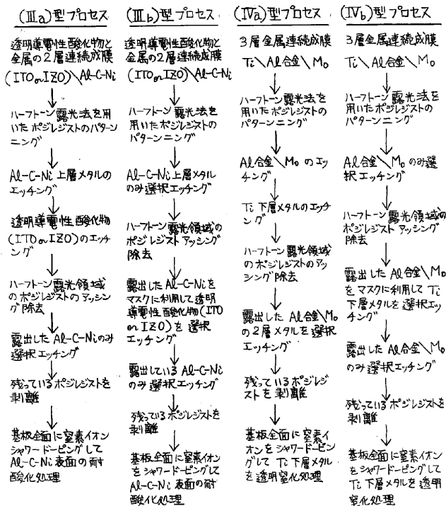
Gate電極 &amp; 画素電極 &amp; 共通電極 (ハフトン露光プロセス)
