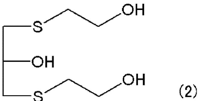
15 une étape (a2) de réaction du composé polyalcool représenté par la formule (2) ainsi obtenu avec de la thiourée en présence de chlorure d'hydrogène pour obtenir un sel d'isothiuronium;
