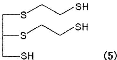
50 einen Schritt (a4) des Zusetzens von Salzsäure mit einer Konzentration von 25 % bis 36 % zu der die so erhaltene Polythiol-Verbindung enthaltenden Lösung und des Waschens der Lösung bei einer Temperatur von 10 °C bis 50 °C, um die durch Formel (5) dargestellte Polythiol-Verbindung zu reinigen.
