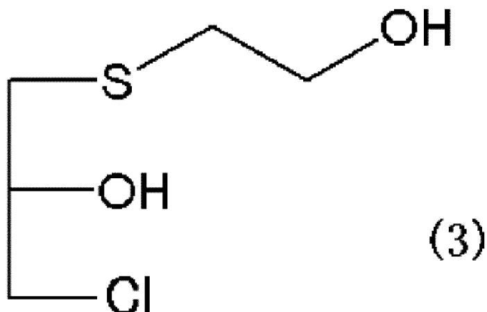
une étape (a1-2) de réaction du composé représenté par la formule (3) avec du 2-mercaptopéthanol à une température de 10 °C à 50 °C pour obtenir le composé polyalcool représenté par la formule (2).
