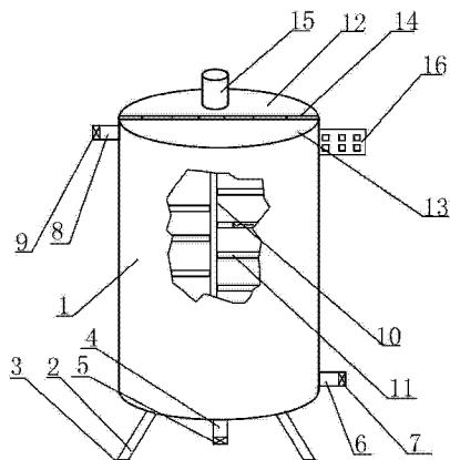
1. 一种湿巾用药液混合罐，其特征在于：包括罐体，所述罐体由白钢制成，所述罐体底部设有支脚，所述支脚底端设有防滑垫，所述罐体下端设有排渣口，所述排渣口上设有排渣阀，所述罐体下部设有出液口，所述出液口上设有出液阀，所述罐体上部设有进液口，所述进液口上设有进液阀，所述罐体内设有搅拌棒，所述搅拌棒上设有搅拌叶片，所述搅拌叶片内设有加热丝，所述罐体顶部设有罐盖，所述罐盖包括固定盖、活动盖，所述固定盖与所述活动盖通过合页连接，所述固定盖上设有电机，所述电机一端与罐体内搅拌棒连接，另一端通过导线与控制器连接，所述控制器设置在罐体的一侧。
