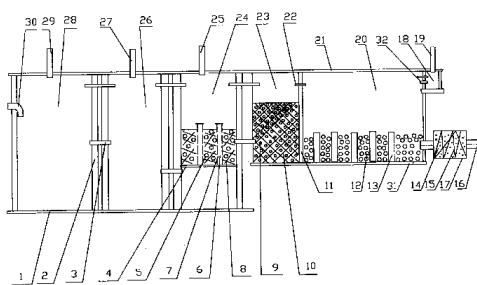
1. 一种小型生活污水处理装置，包括沉淀池、厌氧沉滤池、一级生物滤池、二级滤池和好氧池，好氧池与其它池的底板水平高差为 20—40mm，沉淀池侧壁上装有进水管（30），各池之间通过过水管（3）连通，盖板上装有清掏口（29）、清理口（27）、倒冲式冲洗口（25），其特征在于该装置的一级生物滤池中装有过滤板（4）和滤网（8），过滤板上装有洗料管（6）和生物滤料（5）；二级滤池中装有滤网（10）和复合滤料（9）；好氧池中装有过滤料（12）和阻水墙（13），好氧池的出口位置上装有净水器。
