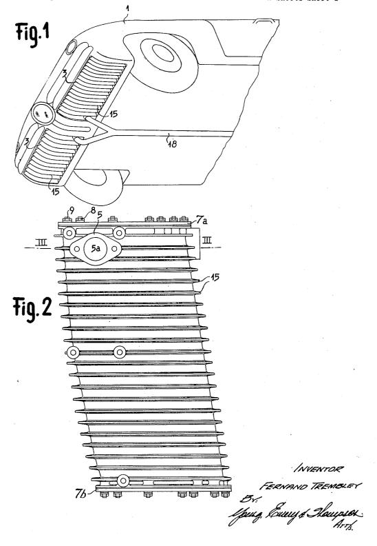
SILENCER FOR INTERNAL-COMBUSTION ENGINES
