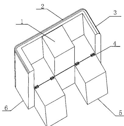
1. 一种多功能沙发，包括沙发座架，所述的沙发座架由靠背(2)、扶手(3)和沙发脚(6)构成，其特征在于所述的沙发还包括与沙发座架通过活动合页(4)转动连接的茶几块(1)和脚凳块(5)。
