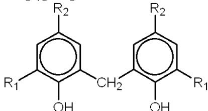
式中、各R<sup>1</sup>は独立してC<sub>1</sub>~C<sub>12</sub>アルキル基からなる群から選択され、各R<sup>2</sup>は独立してHおよびC<sub>1</sub>~C<sub>12</sub>アルキル基からなる群から選択され、アルコキシフェノールのヒンダートビス(フェノール)メタンに対するモル比は0.5/1~2.5/1の範囲であることを特徴とする重合禁止剤組成物。
