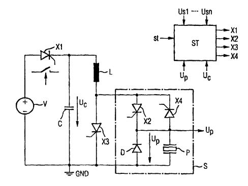
. Kraftstoffeinspritzventils einer Brennkraftmaschine, mittels einer mikroprozessorgesteuerten Steuerschaltung (ST), mit einem von einer Energiequelle (V) nachladbaren Ladekondensator (C), von welchem über von der Steuerschaltung (ST) gesteuerte Schalter (X1 bis X4) das wenigstens eine Stellglied aufgeladen wird, und in welchen sich dieses wieder entlädt.
