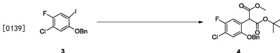
[0140] 氮气保护下,将化合物3 (13.7克) 丙二酸甲基叔丁基酯 (13.1克) 和2-吡啶羧酸 (1.39克) 溶于1,4-二氧六环 (150毫升) 中,室温下依次加入CuI (1.08克) 和碳酸铯 (24.6克)。反应液在75摄氏度下搅拌16小时。反应液过滤,滤液浓缩得粗产品,经硅胶柱层析(乙酸乙酯:石油醚=1:100)纯化,得白色固体13.8克(即化合物4,纯度50%,含大约50%丙二酸甲基叔丁基酯),收率:45%。
