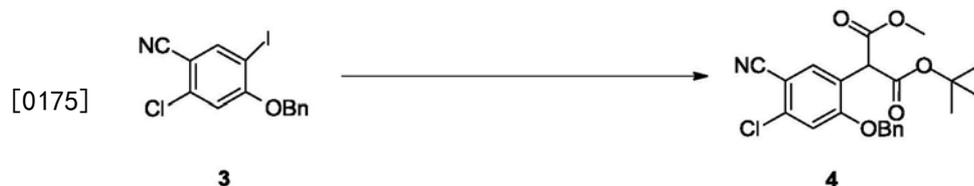
[0176] 氮气保护下,在化合物3 (17.3克) 的1,4-二氧六环 (150毫升) 中,依次加入碳酸铯 (46克)、CuI (9.03克)、2-吡啶羧酸 (2.9克) 和丙二酸甲基叔丁基酯 (16.6毫升)。反应液在85摄氏度下搅拌40小时。反应液浓缩,加水稀释,经乙酸乙酯萃取,无水硫酸钠干燥,过滤。滤液浓缩得粗产品,经硅胶柱层析 (乙酸乙酯:石油醚=1:20) 纯化,得黄色油状物9.6克 (即化合物4),收率:48%。
