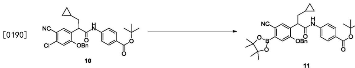
[0191] 氮气保护下, 将化合物10 (800毫克)、联硼酸频哪醇酯 (459毫克)、醋酸钾 (400毫克) 溶于1,4-二氧六环 (7毫升) 后, 加入Pd (PCy<sub>3</sub>)<sub>2</sub>Cl<sub>2</sub> (168毫克)。反应液在120摄氏度下搅拌16小时, 浓缩得粗产品。取化合物10 (800毫克) 重复上述过程。两批粗产品合并后, 经硅胶柱层析 (二氯甲烷: 乙酸乙酯: 石油醚=1:1:10) 纯化, 得两批产品: 1.08克黄色油状物 (即化合物11, 约55%纯度)、678毫克黄色油状物 (即化合物11, 约50%纯度), 合并收率: 50%。
