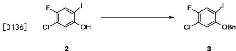
[0137] 氮气保护下,将化合物2 (13.3克) 溶于乙腈 (200毫升) 中,依次加入碳酸钾 (13.6克) 和苄溴 (10.1克)。反应液30摄氏度下搅拌6小时。反应液过滤,滤液经浓缩得粗产品。经硅胶柱层析(乙酸乙酯:石油醚=1:100)纯化,得白色固体13.7克(即化合物3),收率:77%。
