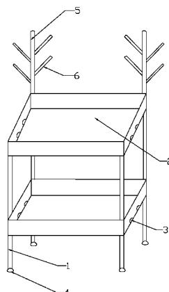
1. 一种实用鞋架,包括支腿和置物槽,其特征是,所述的支腿底端设有防滑垫,所述的置物槽侧壁的底端设有排水孔,置物槽上方设有竖直的立柱,立柱的侧壁上设有挂钩。
