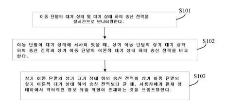
상기 이동 단말의 상기 대기 상태 하의 송신 전력과 상기 이동 단말의 이론적 대기 상태 하의 송신 전력을 비교 하고, 또한 비교 결과를 상기 소프트웨어 프롬프트 모듈로 통지하도록 설정되는 비교 모듈 비교 결과가 상기 이동 단말의 상기 대기 상태 하의 송신 전력이 상기 이동 단말의 이론적 대기 상태 하의 송신 전력보다 클 때, 사용자에게 현재 상태 하에서 정보 악의적인 정보 유출 위험이 존재함을 프롬프팅하도록 설정되는 소프트웨어 프롬프트 모듈이 포함되며, 본 방법과 시스템을 이용하면 판단 정확도가 높고, 사용자 정보의 비정상적인 유출을 방지하여 이동 단말 사용자의 정보 보안성을 향상시킨다.
