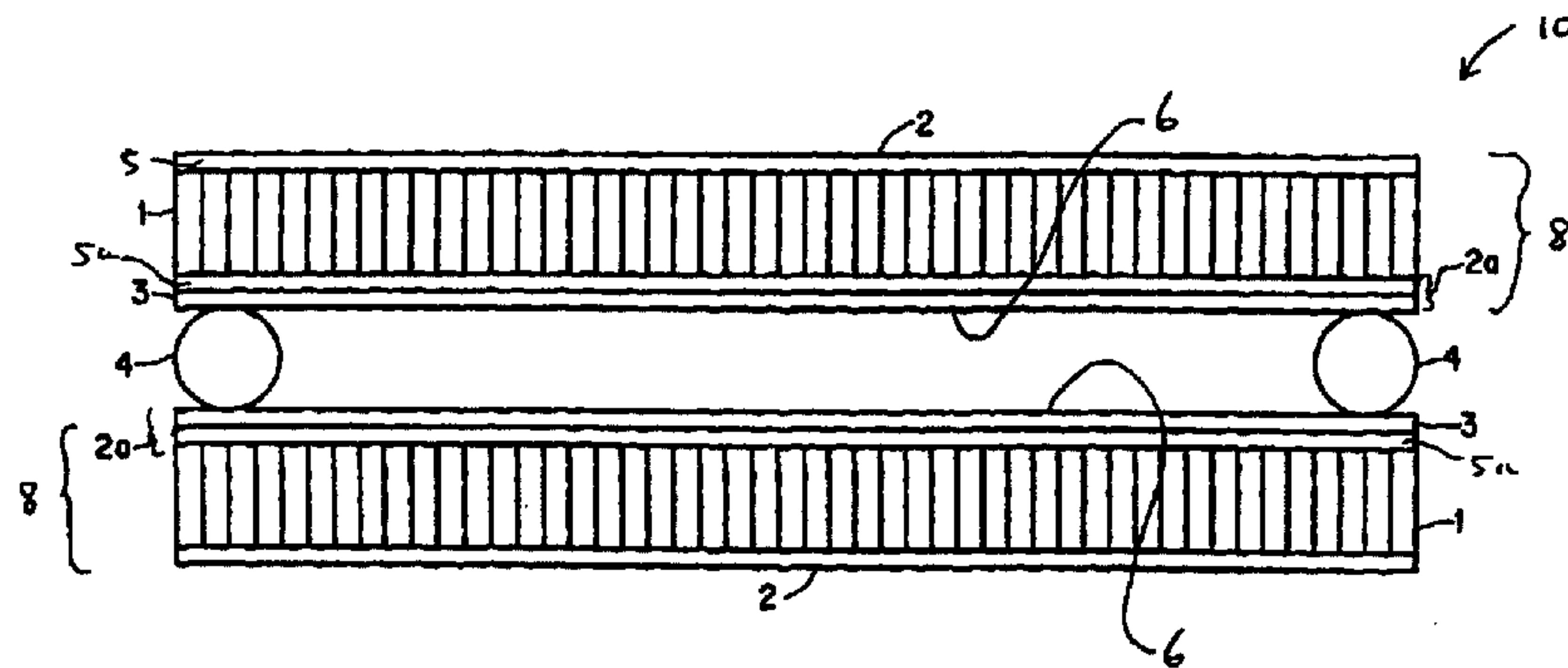
(57) La présente invention se rapporte à un moule conçu pour une matière susceptible de subir une réticulation à induction chimique. Ce moule comporte une première partie de coque, une seconde partie de coque et une âme en nid d'abeilles intercalée entre les deux parties de coques. L'invention se rapporte également à la création, au moyen du moule précédemment décrit, d'un environnement sensiblement adiabatique pour des compositions réticulées par induction chimique.
