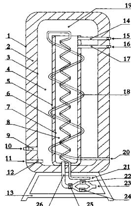
1. 一种热泵热水器的换热保温装置,在能承受自来水压力的保温容器上设有进水口和出水口,所述保温容器里的水与换热管直接或间接接触,其特征是:有一结构将所述保温容器的内腔分隔成加热腔、蓄热腔和连通腔,或分隔成加热腔和蓄热腔,加热腔和蓄热腔之间有管道连通;加热腔与蓄热腔上部连通;连接压缩机高压端的换热管从所述保温容器的下部穿入,进入蓄热腔后盘绕上行,至蓄热腔上部折入加热腔,然后盘绕下行,或紧贴于所述结构的外壁的背面盘绕上行,在接近所述结构的上端处折回,紧贴于所述结构的内壁的背面盘绕下行,直至从所述保温容器的下部穿出与蒸发器相连接;进水管从所述保温容器的下部穿入至加热腔,出水管从所述保温容器的下部穿入至蓄热腔;所述结构的外壳和内壳之间设有隔热层。
