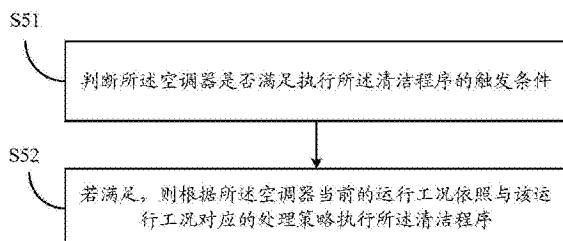
1. 一种空调器的清洁方法,利用空调器中的换热器将空调器中的水蒸气冷凝成液态水,将附着在所述换热器的表面的污垢清除,其特征在于,在执行清洁程序之前,还包括:
