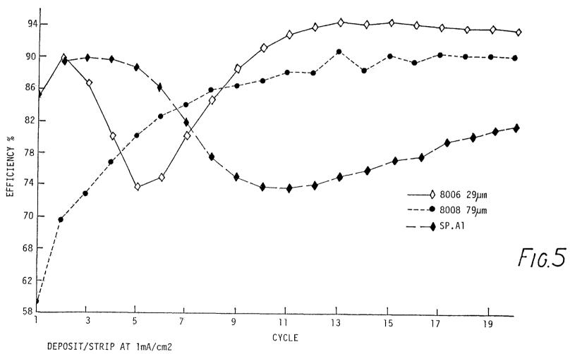
DEPOSITING AND STRIPPING EFFICIENCES OF LITHIUM ON A1-ALLOYS IN 1M LiBF4/PC
