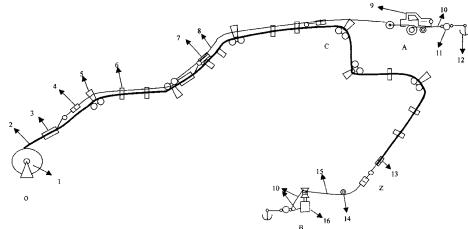
1、一种超长大截面电缆的机械敷设方法，其特征是使用牵引机作为牵引动力，在电缆敷设过程中采用主牵引和中继辅助牵引两种方式共同进行牵引敷设，其中所述主牵引为牵引机的牵引绳与欲敷设电缆的起始端头连接进行牵引，所述中继辅助牵引为牵引机的牵引绳与电缆中继牵引点连接进行牵引。
