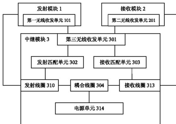
1. 一种级联无线充电装置,包括发射模块(1)和接收模块(2),其特征在于:还包括中继模块(3),中继模块(3)包括第三无线收发单元(301)、发射匹配单元(302)、接收匹配单元(303)、耦合线圈(304)、发射线圈(310)、接收线圈(313)和电源单元(314),发射模块(1)和接收模块(2)分别将发射端频率信号和接收端频率信号发送到第三无线收发单元(301),第三无线收发单元(301)分别通过发射匹配单元(302)和接收匹配单元(303)对发射线圈(310)的阻抗和接收线圈(313)的阻抗进行匹配,发射线圈(310)接收发射模块(1)发射的电磁波能量信号并耦合到耦合线圈(304),耦合线圈(304)将电磁波能量信号分别传递给电源单元(314)和接收线圈(313),接收线圈(313)将电磁波能量信号传递到接收模块(2)。
