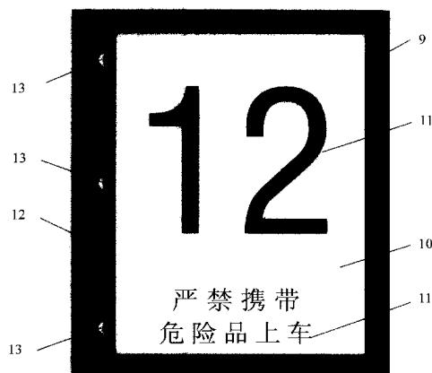
1. 一种 LED 发光显示板，包括有一个四边形的框架(9)，框架内侧有内槽，四边的内槽卡装显示板(10)，在显示板(10)上有显示标识(11)，四边形的一侧框架内有空腔(12)，LED 发光管(13)和供电电路及其附件安装空腔(12)内，框架(9)相对侧内也有空腔，安放 LED 发光管(13)、LED 发光管(13)驱动电路，其特征是：显示板(10)为层状板结构，以反光层(20)为中心层，在其两侧依次对称配置有导光板(21a)、(21b)、标识层(22a)、(22b)、标识层(22a)、(22b)外覆盖透明基板(24a)、(24b)，标识层(22a)、(22b)的有效标识部分涂发光材料(23a)、(23b)，标识层(22a)、(22b)的非有效标识部分为遮光材料，LED 发光管(13)装在四边形的框架(9)导光板(21a)、(21b)左右或上下两侧。
