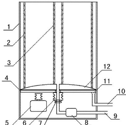
1. 节水高效洗衣机,包括机壳、电机,其特征在于:机壳内的底盘上部设置外筒和内筒,内筒置于外筒内,外筒和内筒上均设置密布透水孔;内筒内形成进水空腔,进水空腔通向进水管;外筒和内筒间放置衣物;机壳与外筒间形成排水空腔,排水空腔下方设置排水口,排水口通向排水管;转盘置于底盘上,转盘下方设置转轴,转轴通过轴承与底盘连接,转轴上的转轴轮通过皮带连接电机。
