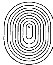
ATTENUATION -3 dB 20 MICRON APERTURE
