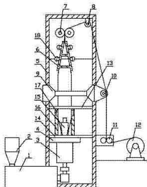
1. 一种新型高效吹膜机，包括挤出机、进料斗、模头、风环、安装架、人字夹板、压延辊、A 导向辊、固定横架、B 导向辊、牵引辊、卷取辊，其特征在于：还包括上轨道、下轨道、吹塑芯、可调弧形板、感压片、离子风棒，所述挤出机的进口端设有进料斗，所述模头安装在挤出机的出口端，所述模头的上端设有风环，所述风环的中心处设有吹塑芯，所述风环的上端的安装架上设有下轨道、上轨道，两个所述可调弧形板通过上轨道、下轨道安装在风环的上端，所述可调弧形板的内侧设有感压片，所述固定横架安装在上轨道上端的安装架上，所述固定横架的右端设有 B 导向辊，所述人字夹板安装在固定横架上端的安装架上，所述人字夹板上对称设有离子风棒，所述压延辊安装在人字夹板上端的安装架上，所述安装架的顶部设有 A 导向辊，所述 B 导向辊下端的安装架上设有牵引辊，所述牵引辊的后端设有卷取辊。
