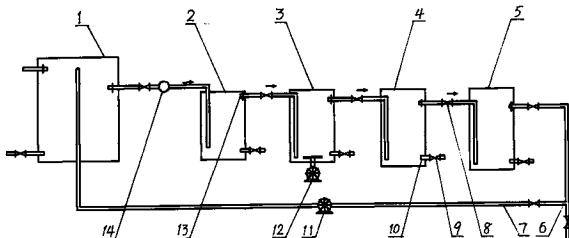
1. 一种沼液生态净化装置，其特征是由前至后依次有调节槽（1）、兼氧槽（2）、好氧槽（3）、养鱼槽（4）和澄清槽（5），五个槽均有出液管和进液管，前一槽的出液管与后一槽的进液管连通，其间有控制阀（8），位于最后的澄清槽（5）的出水经三通管（6）及其控制阀，分别接排出管与回流管（7），回流管与最前的调节槽（1）连通，调节槽的出液管上有流量计（14），回流管（7）上有循环水泵（11），好氧槽（3）内有曝气装置（12）和填料。
