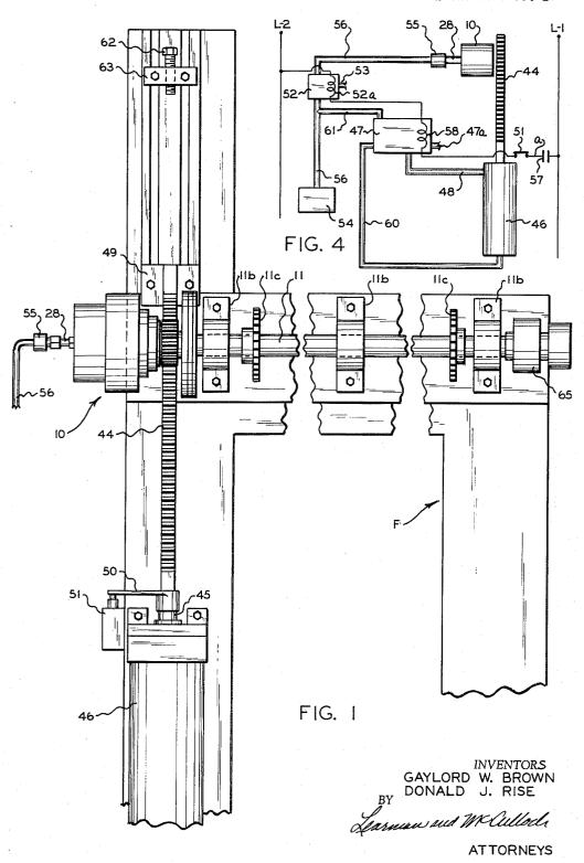
FLUID PRESSURE OPERATED CLUTCH
