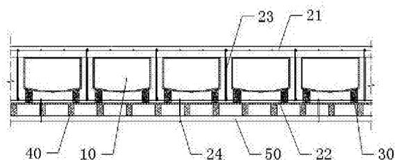
1. 一种现浇混凝土竹芯楼板结构,其特征在于,包括支模系统和模板,所述模板设于所述支模系统上,所述模板上方均匀铺设若干定位砼垫块,所述定位砼垫块上方设有竹芯芯模,所述芯模上方设有若干平行的抗浮压筋,所述芯模的下方设有若干板底钢筋,板底抗浮铁丝的上端与所述板底钢筋的板底上皮钢筋连接,所述板底抗浮铁丝的下端穿过所述模板与所述支模系统固定连接,所述芯模固定好后,所述抗浮压筋通过抗浮铁丝与所述板底钢筋的板底下皮钢筋拉结固定,所述芯模之间的空隙内浇筑有混凝土。
