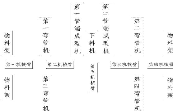
1. 一种空调管路加工系统,其特征在于,所述系统包括中控装置、弯管机、管端成型机、下料机、以及机械臂;其中,所述中控装置用于控制系统内各装置的动作,所述机械臂用于在所述弯管机、所述管端成型机、以及所述下料机之间运输待加工管料或加工成品。
