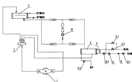
1、一种可自动反冲洗污水的水源热泵机组，它包括由压缩机(1)、冷凝器(2)、膨胀阀(10)、蒸发器(4)和四通阀(7)组成的压缩蒸发冷凝机组，冷凝器(2)和蒸发器(4)均为水换热器，其特征在于，所述蒸发器(4)的供水管路上依次串接有与污水源连接的过滤器一(8.1)、水泵(9)、三通阀(6)和过滤器二(8.2)，蒸发器(4)的回水管路上串接有与排水池连接的电动阀二(5.2)，在蒸发器(4)的进、出口之间并联连接有压差传感器(3)，在过渡器二(8.2)和三通阀(6)的连接处与电动阀二(5.2)的出口端之间并联连接有电动阀一(5.1)，三通阀(6)的另一出口与电动阀二(5.2)的进口端连接，蒸发器(4)的顶端设有排污管，排污管上置有电动阀三(5.3)。
